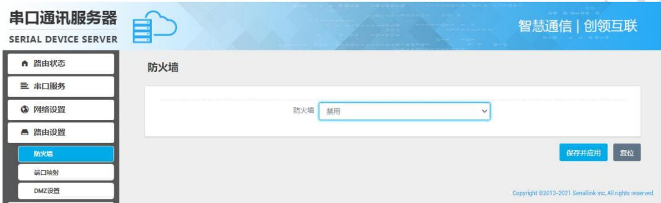
点击路由设置>>>DMZ 设置，点击启用，设置 lan 口给下接设备分配的 ip 地址，将下接设备所有的端口转发出来，通过 wan 口的 ip 地址可以直接访问。
