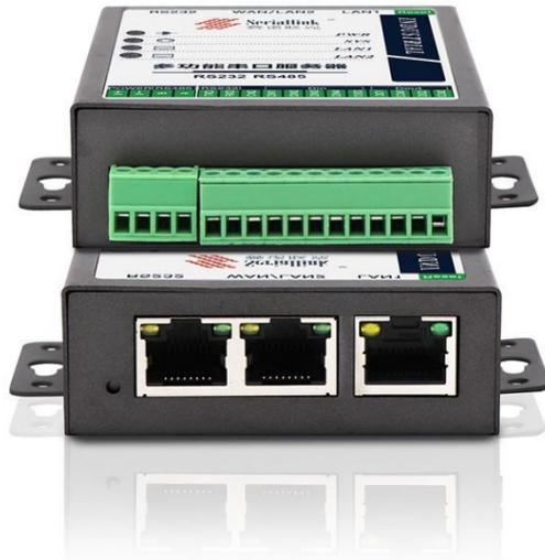
赛诺联克（SERIALLINK）SLK-S502 串口服务器是将多路分散的，低速的，不同标准的串口设备转换成以太网进行集中管理，安装虚拟串口之后可以实现对串口数据的远程读取。SLK-S502 串口服务器支持多种工作模式，其中 TCP 服务端模式、TCP 客户端 模式、UDP 模式、TCP/UDP Socket, Modbus RTU 转 Modbus TCP Server 等工作模式，允许用户软件通过 TCP 加端口号访问串行设备。另外，也支持虚拟串口的方式访问串行设备。赛诺联克（SERIALLINK）SLK-S502 支持通过浏览器 或 Telnet 终端方便快捷地手动配置 IP 地址。同时，用户也可以通过简单易用的 Windows 管理软件自动搜索局域网内的串口服务器设备，并进行远程配置管理和工作状态监测等应用。
