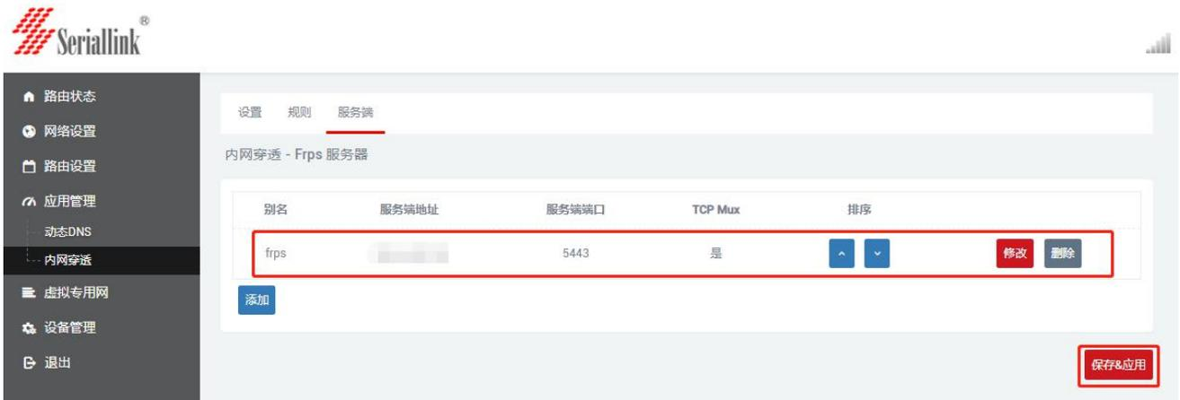
(4) 接下来进入“内网穿透”的“设置”页面，启动 frpc 客户端，按照下图进行配置，配置完成后，点击“保存&应用”，配置完成后“设置”页面会出现“服务正在运行”，证明 frp 客户端已经启动了。
