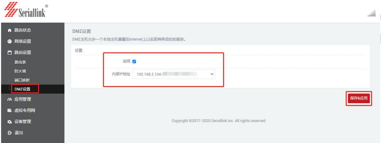
查看 wan 口 ip, 通过 wan 口的 ip 可以直接访问下接设备了, 如果访问不了可能原因是下接设备开了防火墙, 需要将下接设备的防火墙关闭。
