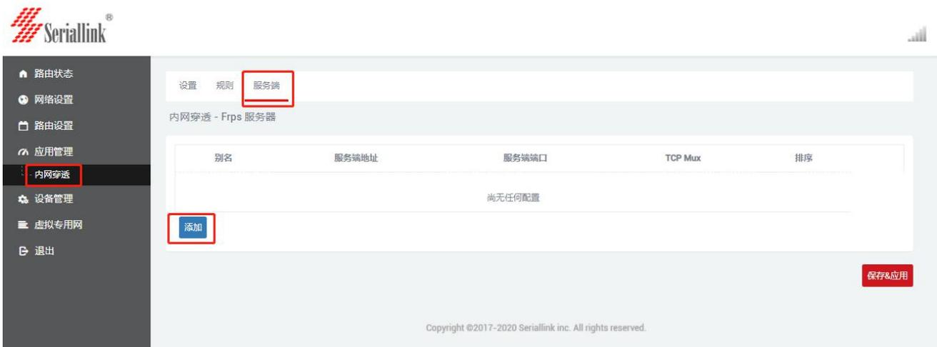
(2) 点击“添加”或“修改”后会弹出一个编辑 frps 服务器的页面，根据服务端的设置进行配置，配置完成后点击“保存&应用”。
